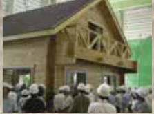
国立土木研究所での実台耐震実験 2006年
